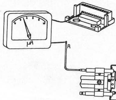
Отсоедините ионизационный кабель "А" от клеммы блока управления (см.таблицу). Подсоединение микроамперметра производится последовательно согласно приведенного рисунка.
